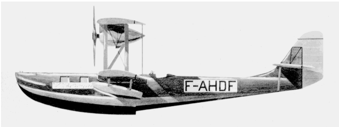
LeO H-134 « Clément-Bayard » à moteur 12 cylindres Lorraine unique de 450 ch (1925). (Cliché L'illustration).
