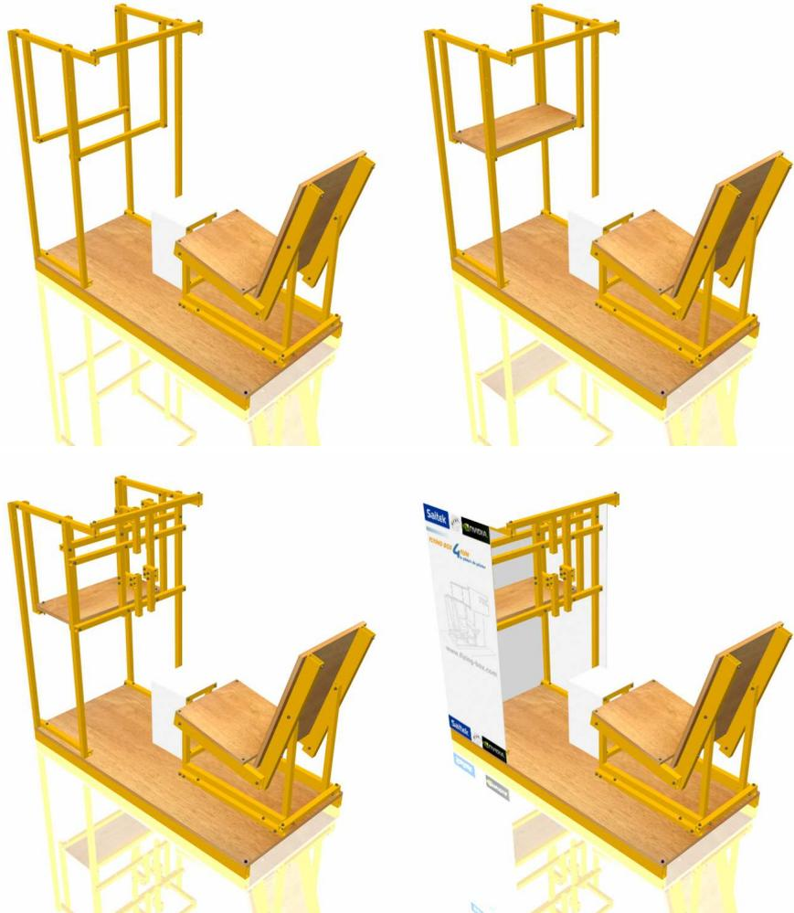
*Montage de l'armoire informatique en plusieurs étapes : d'abord la structure avec le berceau pour l'ordinateur, puis les supports écran pour les deux écrans centraux et enfin les panneaux décorés en aluminium.*
